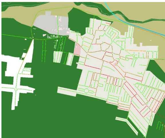
Figura nr 24 Viteza medie de deplasare în rețea ora de vârf dimineață simulare 2030 - harta realizată cu SUMO
