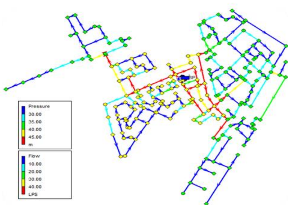
Figure 22. Rețeaua de distribuție a apei din orașul, Tei-Colentina, simulare: Presiune – debit.
