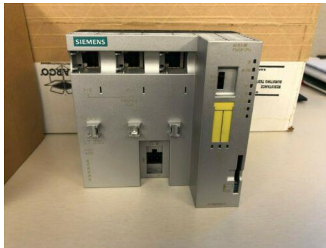
Fig. 3.12. Siemens PLCs ET-200S IM151-8
