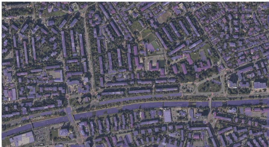
Figura 5.25. Ampretele la sol ale construcțiilor obținute cu modelul antrenat de Deep Learning
