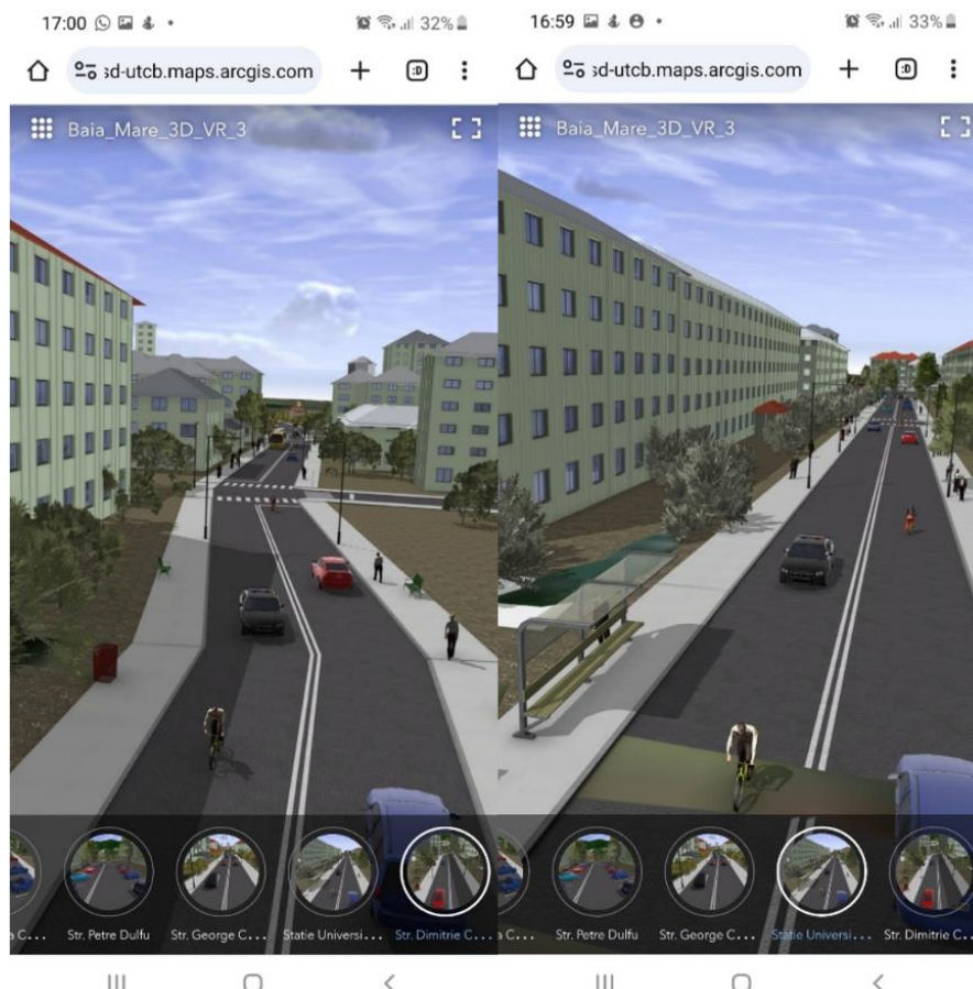
Figura 5.50. Vizualizarea modelului 3D AR al unei zone din Municipiul Baia Mare, generat pe baza norului de puncte LiDAR și a imaginilor fotogrammetrice
