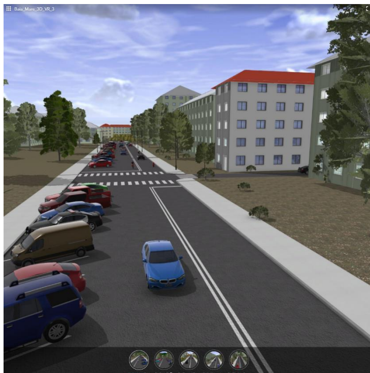
Figura 5.48. Vizualizarea modelului 3D AR al unei zone din Municipiul Baia Mare, generat pe baza norului de puncte LiDAR și a imaginilor fotogrammetrice
