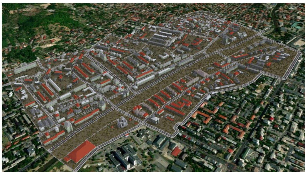
Figura 5.4. Modelarea zonei în CityEngine cu nivelul de detaliere LOD 3 (LOD3.1, conform clasificării realizate de Biljecki et al. (2016)), vedere de ansamblu
