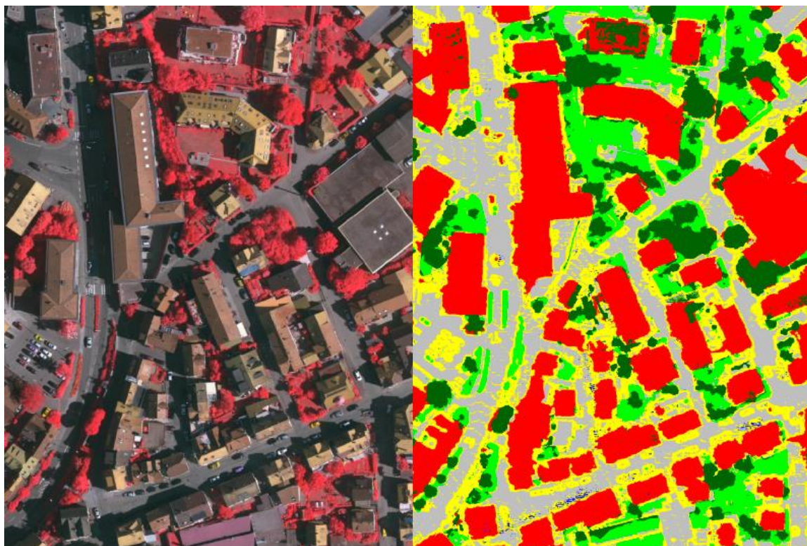
Figura 3.1. Imagine ortorectificată (în partea stângă) și rezultatul clasificării imaginii (în partea dreaptă): roșu-construcție, verde închis-copac, verde deschis-vegetație joasă, gri-suprafață impermeabilă, galben-mașini (Höhle, 2017)
