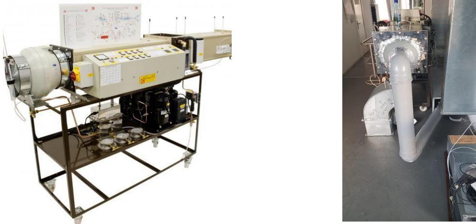
Fig. 9 – Echipamentul Air Conditioning Laboratory Unit P.A. Hilton utilizat pentru conectarea cabinei la sistemul HVAC
