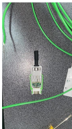
Fig. 4 – Conectarea senzorilor Almemo
