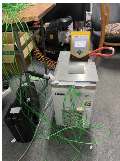
Fig. 6 – Calibrarea termocupurilor si caracteristicile tehnice ale băii temostatate
