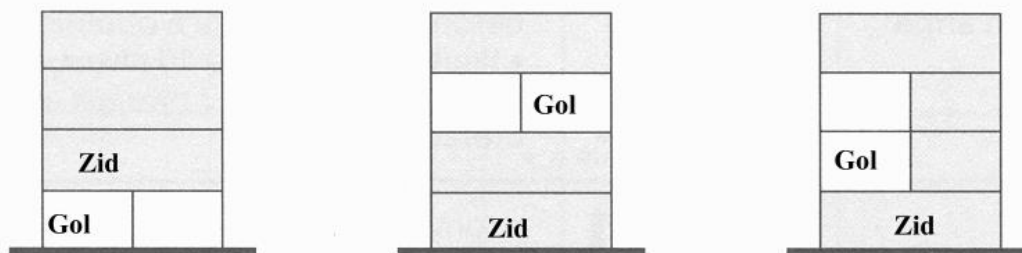
Figura 4 Clădiri cu niveluri "slabe"(neregularitate structurală în elevație)
