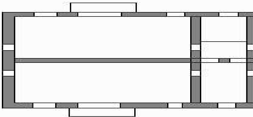
Figura 7 Structura cu pereți dispuși în „sistem sală”
