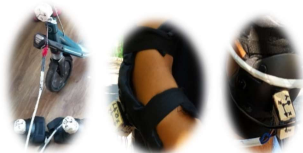
Figura 23 Trotinetă, cotieră, genunchieră cu accelerometre
