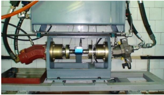
Fig. 6 Servomotorul Bosch tip EP2 din secundarul transmisiei hidrostatice (dreapta), cuplat la dispozitivul hidraulic de simulare a sarcinii.
