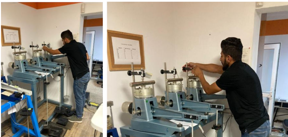
Figură 49 Teste edometru pentru sol tratat cu procente diferite de nanomateriale.
