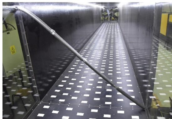
Figura III-4 – Model la scară final (cablul netensionat)
