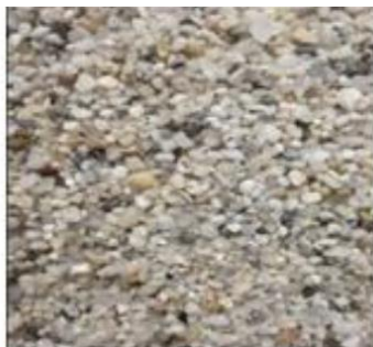
Figura 3.4. Material filtrant – nisip de filtru.
