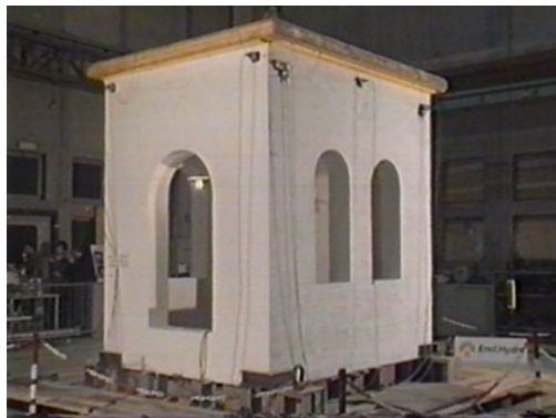
Fig. 5.4.3. Înainte de încercarea pe masa seismică [47]
