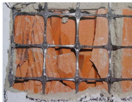
Fig. 5.4.6. Modelul cu cărămidă cu goluri – cărămida s-a degradat iar grilele au rămas intacte [47]
