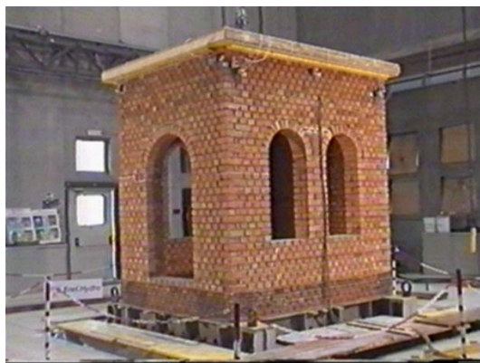
Fig. 5.4.1. Înainte de încercarea pe masa seismică [47]
