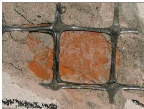
Fig. 5.4.5. Modelul cu cărămidă plină – cărămida a rămas intactă iar armătura a cedat [47]
