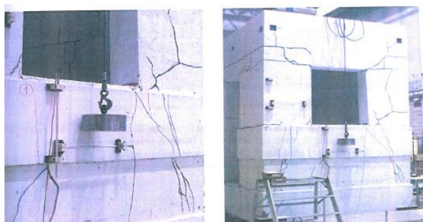
Fig. 6.1.1. Punctul 1 pe centura de tencuială armată [23]
