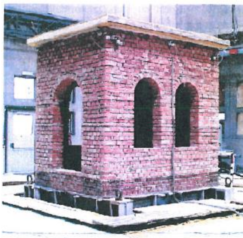
Fig. 3.2.1. Modelul 3D de zidărie din cărămizi pline [4]
