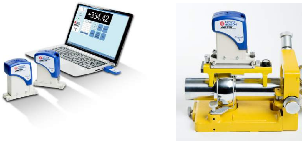
Figura 3.22 Nivelă electronică Talyvel (Taylor Hobson) [21]
