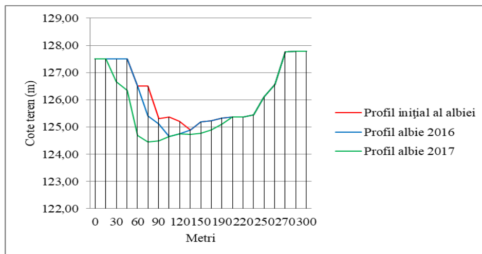
Fig.3.3. Evoluția profilului transversal în zona (amonte A) în perioada 2016-2017
