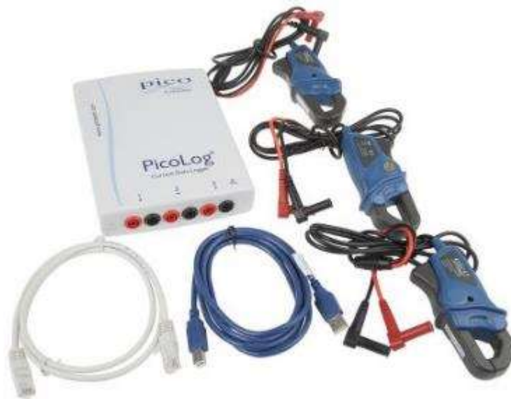
Figura 48 Aparatul de achizitie de date de tip curent si clesii ampermetrici utilizati
