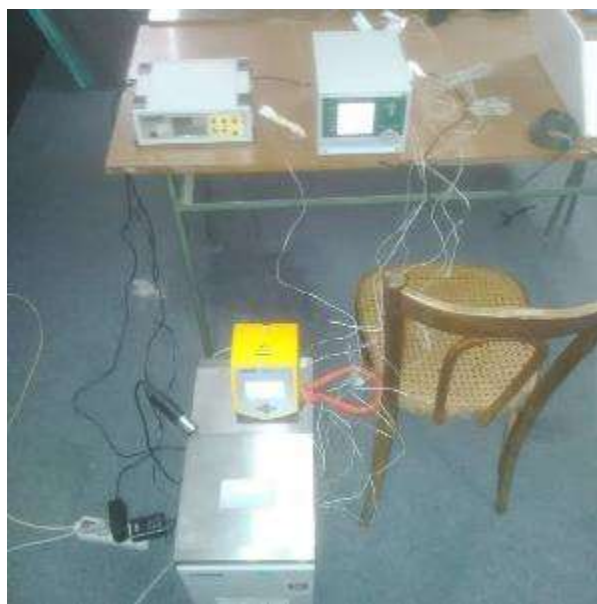
Figura 54 Bancul de calibrare termocuple
