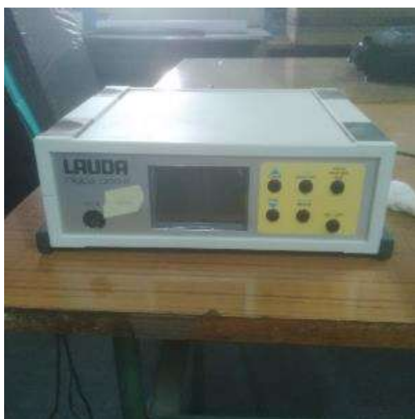
Figura 55 Statia de calibrare a termocuplelor
