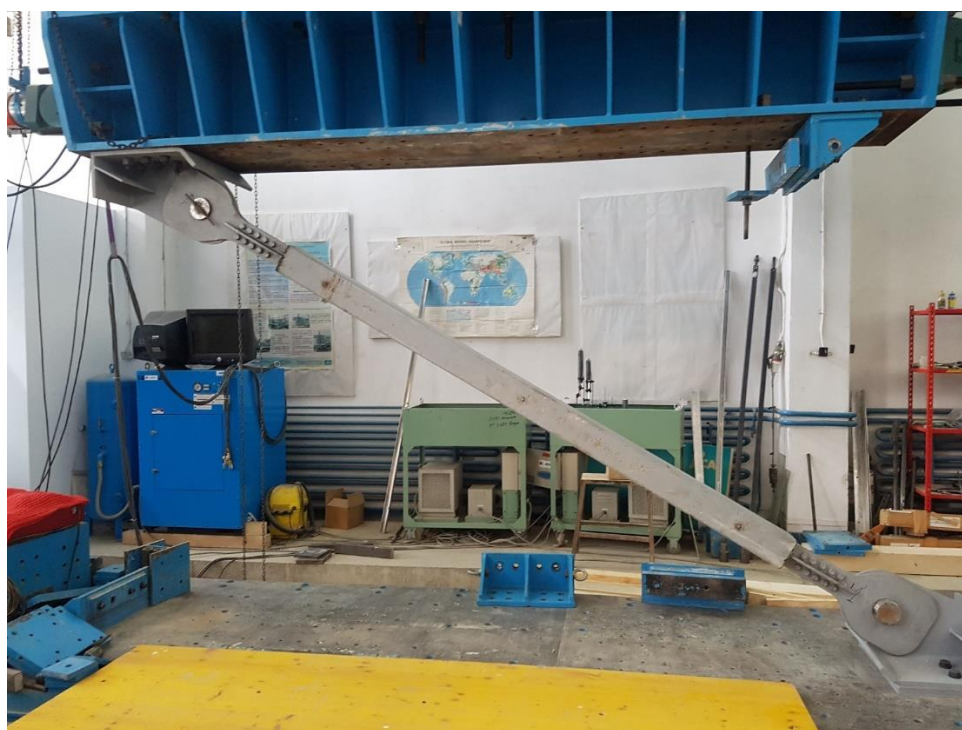
Fig. 3.9 – Montajul in pozitia de testare al prototipului BRB
