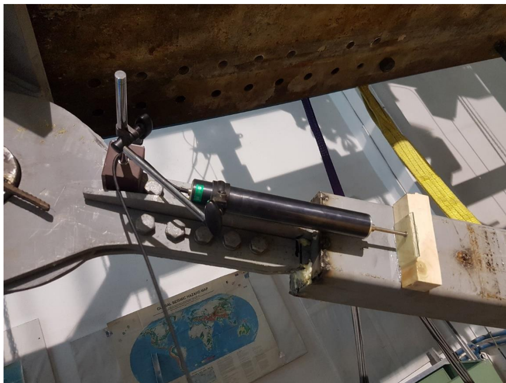
Fig. 5.7 – Montajul traductorului nr.3
