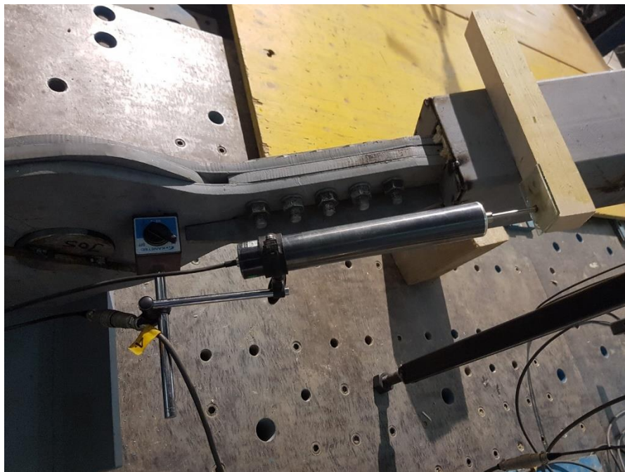
Fig. 5.3 – Montajul traductorului nr.4
