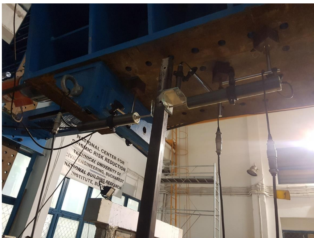
Fig. 5.5 – Montajul traductoarelor nr.1, nr.2 si nr.5
