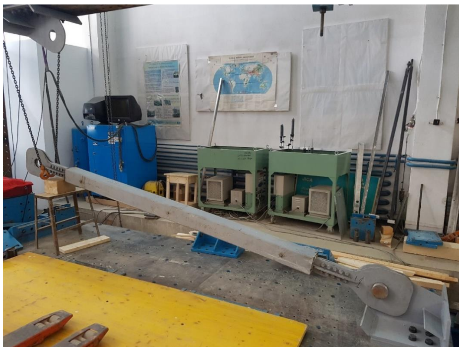
Fig. 3.7 – Montajul in pozitia de testare al prototipului BRB
