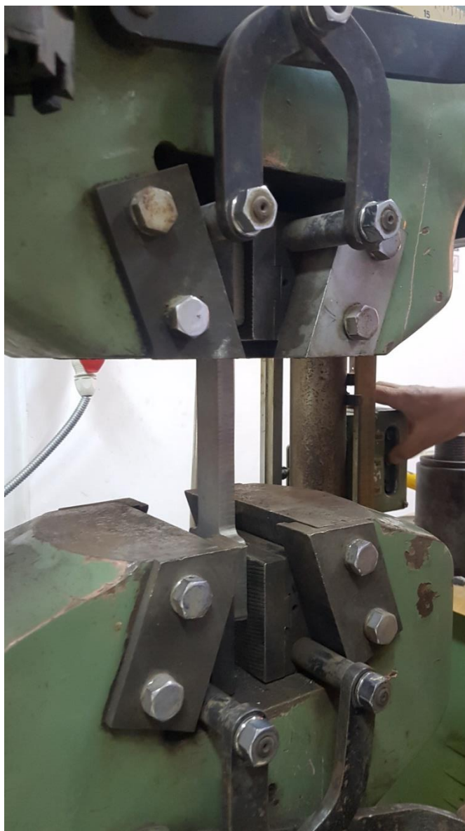
Fig. 6.2 – Testarea la tractiune a epruvetelor standardizate
