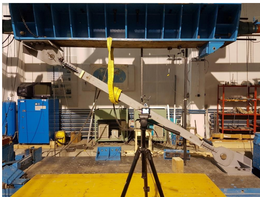
Fig. 5.11 – Montajul traductoarelor pentru specimenul BRB
