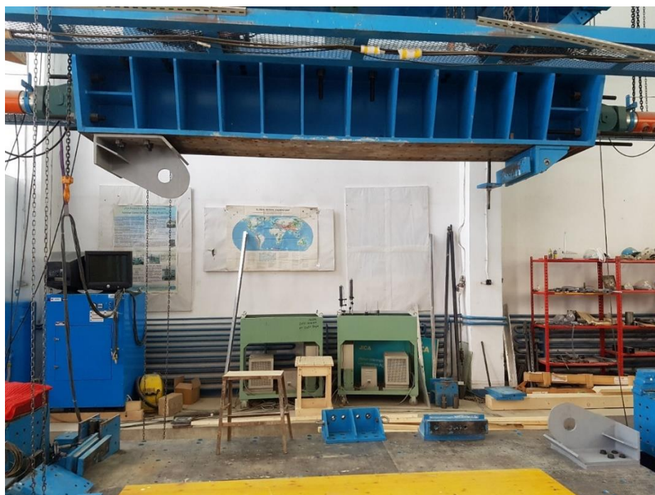
Fig. 3.6 – Cadru seismic si elemente de prototipului BRB
