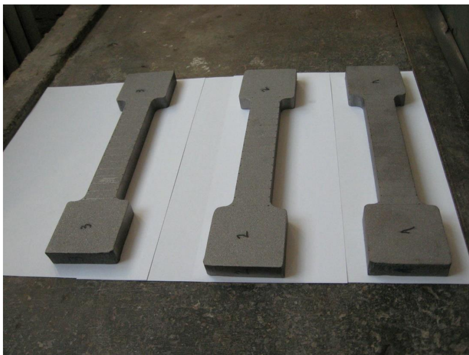
Fig. 6.4 – Marcarea reperelor pe epruvete pentru testarea la tractiune
