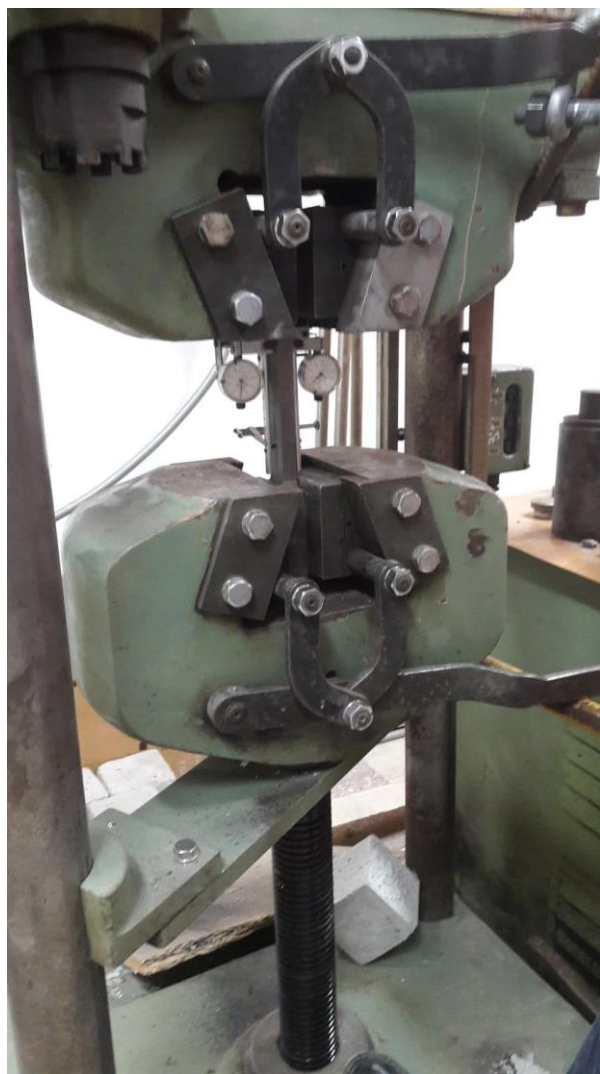
Fig. 6.3 – Testarea la tractiune a epruvetelor standardizate
