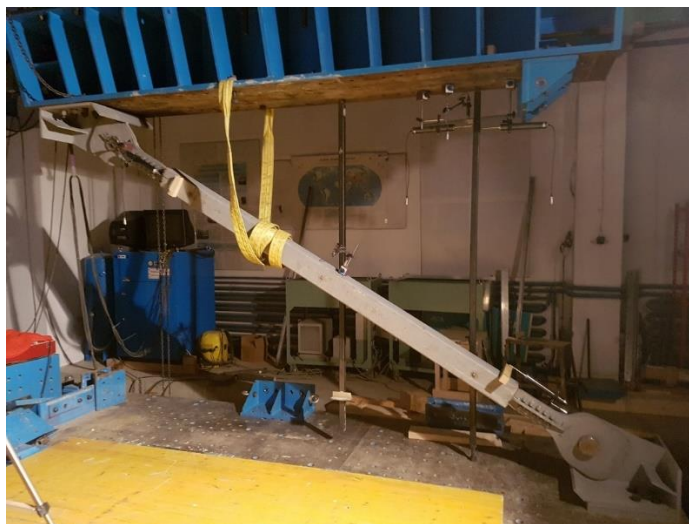
Fig. 5.1 – Montajul traductoarelor pentru prototipul BRB
