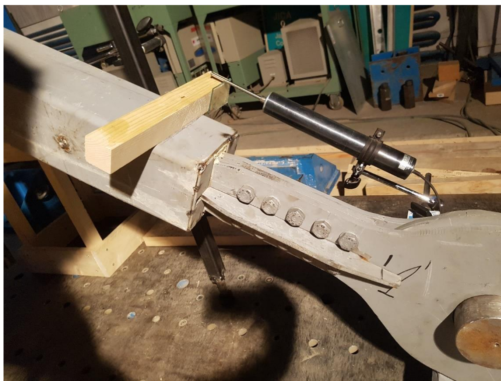
Fig. 5.9 – Montajul traductorului nr.4
