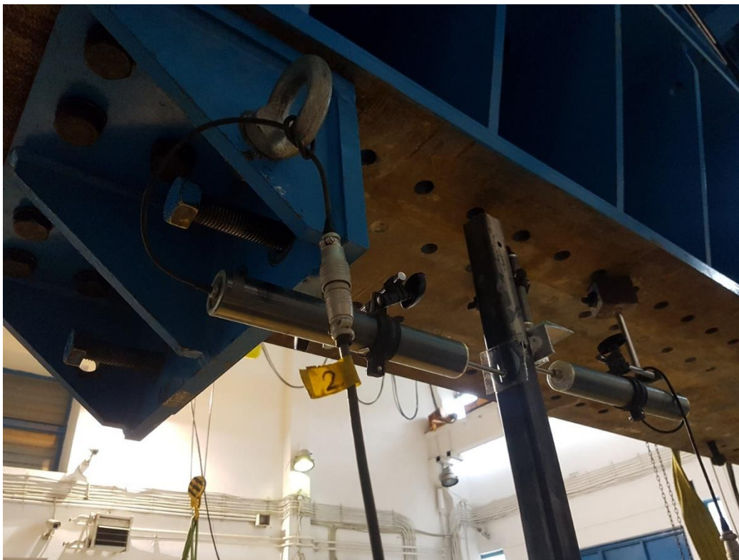
Fig. 5.6 – Montajul traductoarelor nr.1, nr.2 si nr.5
