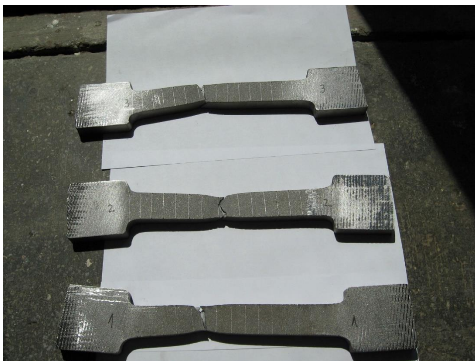
Fig. 6.5 – Epruvetele testate la tractiune
