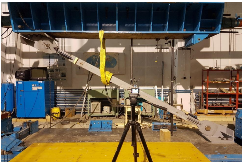
Fig.3 – Testarea prototipurilor de bare cu flambaj împiedicat
