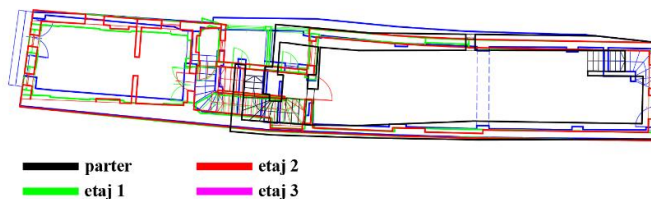
Figură 6.8 – Variații pe verticală ale grosimilor de pereți și neliniarități geometrice
