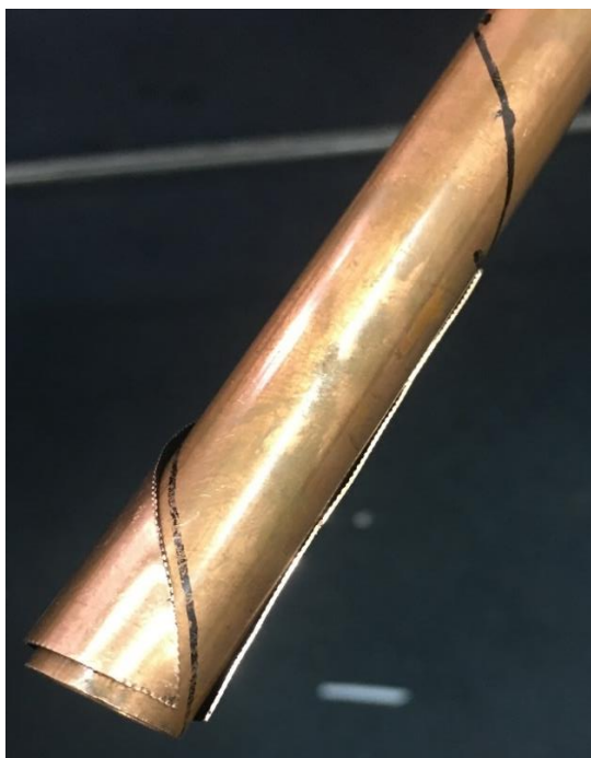
Imaginea 4-11. Localizarea pieselor din cupru pe țeavă.
