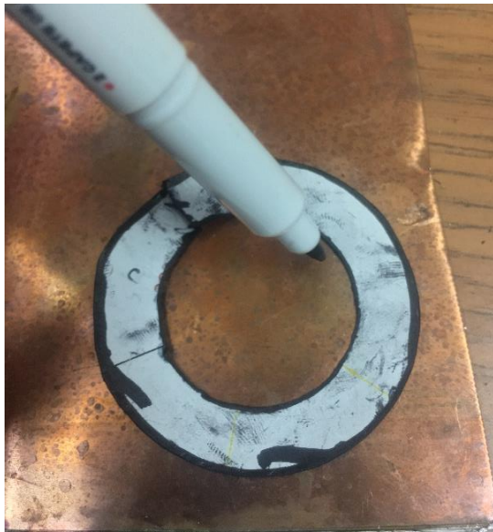
Imaginea 4-9.Proiectarea planului pe placa din cupru.
