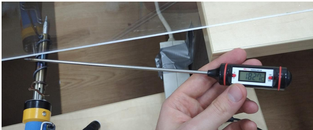
Fig 9. Măsurarea temperaturii serpentinei lichidului de fum
