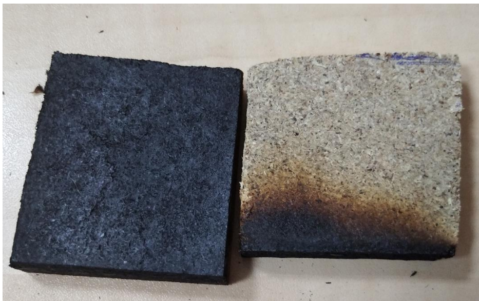
Fig 25. Afectarea probelor de PAL
