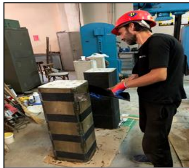
b) Wrapping CFRP strips
