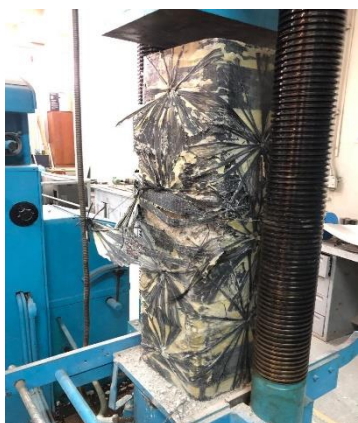
Fig. 4-2 d: Mod de cedare a coloanei ranforsate (CP-6).
