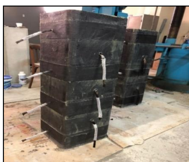
d) Inserarea corzii MapeWrap FIOCCO în fiecare orificiu.
