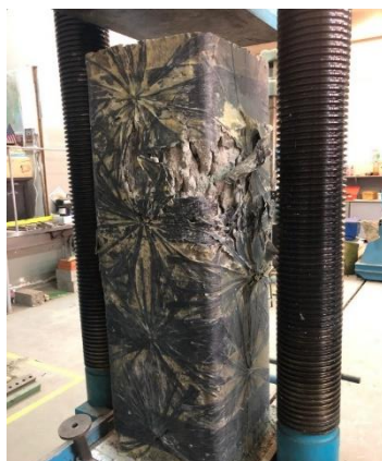
Fig. 4-3 e: Mod de cedare a coloanei ranforsate (CP-7).
