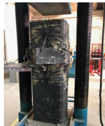
Fig. 4-3 f: Mod de cedare a coloanei ranforsate (CP-8).
