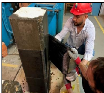
c) Aplicarea rășinii epoxidice MapeWrap
