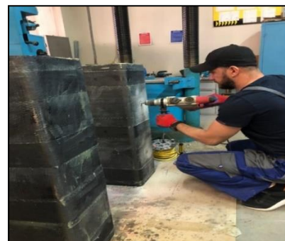
c) Executat orificii pentru elementele de fixare.
