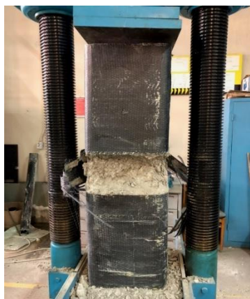
Fig. 4-2 a: Mod de cedare a coloanei ranforsate (CP-3).
