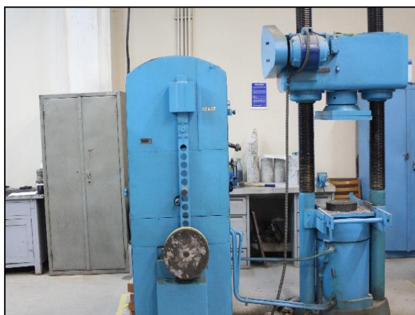
Fig. 3-4: Mașină universală de testare folosită pentru a testa coloanele din beton.
