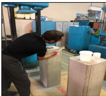
a) Curățarea suprafeței de beton.
