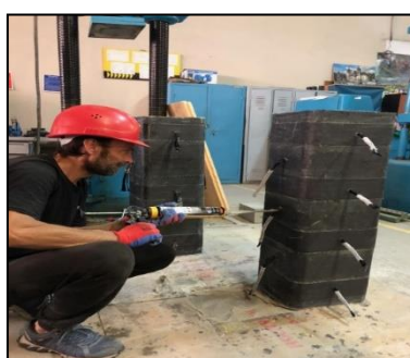
e) Injectarea fixatorului Mapefix VE SF 300 pentru a umple orificiile.
