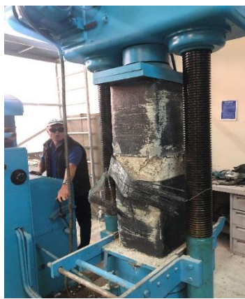
Fig. 4-2 b: Mod de cedare a coloanei ranforsate (CP-4).
