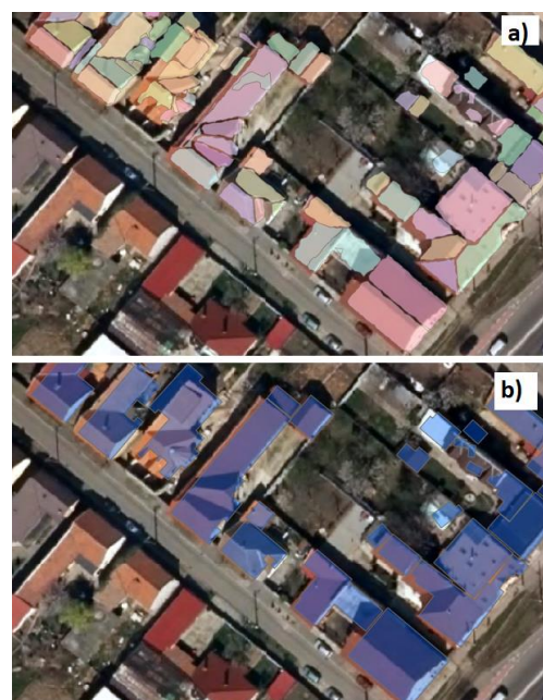
Figura 6.7 Amprețele la sol ale clădirilor a) rezultatele segmentării; b) rezulatele postprocesării
