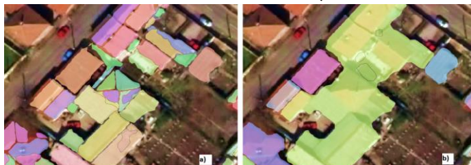
Figura 6.5 Poligoanele contur clădiri rezultate pe baza segmentărilor a) prin metoda extragerii planurilor; b) prin metoda grupării condiționate varianta 2
