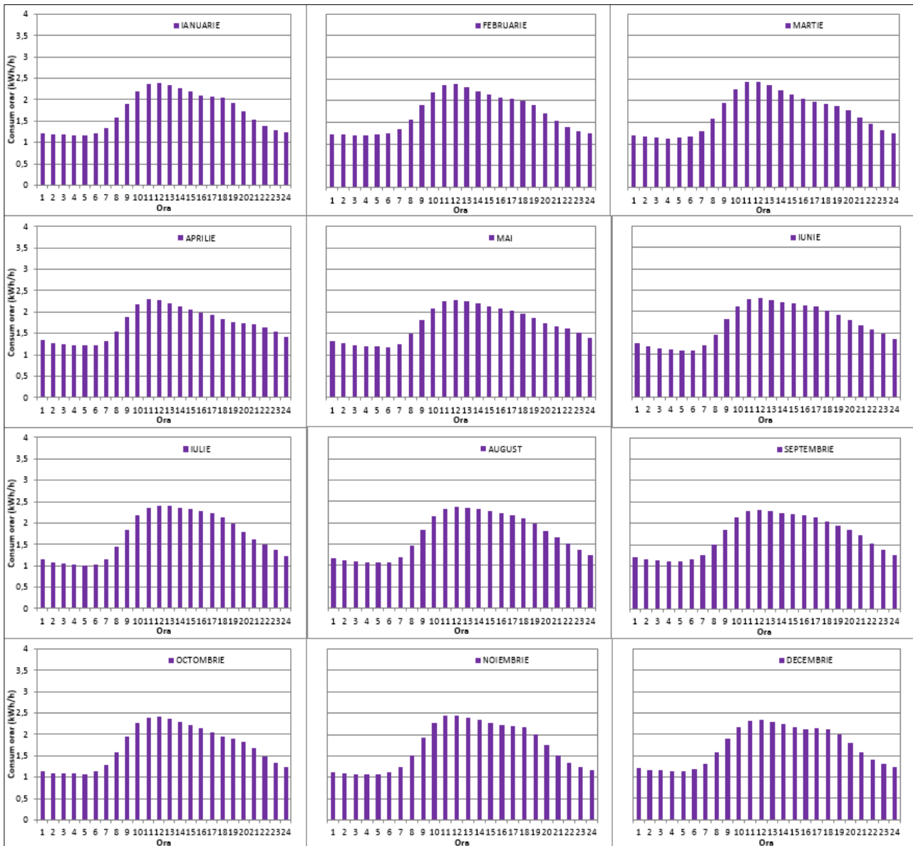
Figura 2.6 Profil consum electric - iluminat, rezidențial
