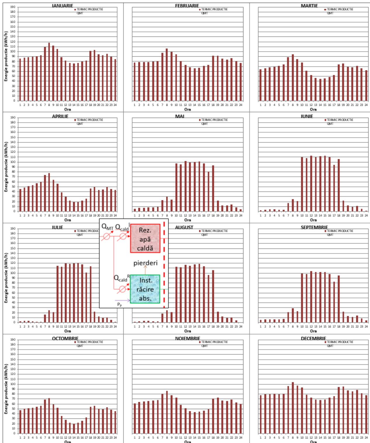
Fig. 4.4. Profiluri orare de energie termică totală produse în regim de cogenerare, rezidențial
