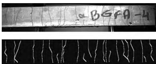
Fig. 2.3: Distribuția fisurilor în AR-FRCM [27].
