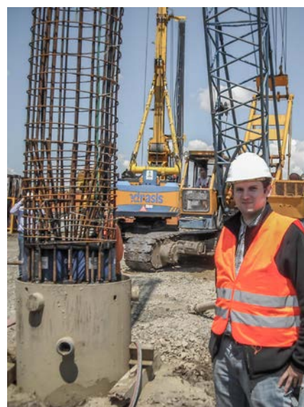
Figura 4. Celulele de presiune O-Cell pentru încercarea de tip Osterberg pentru încercările LT2 (stânga) și LT1 (dreapta)
