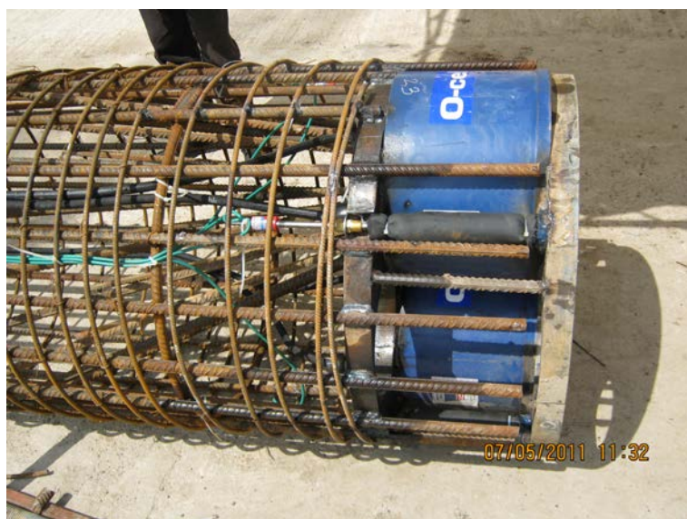
Figura 4. Celulele de presiune O-Cell pentru încercarea de tip Osterberg pentru încercările LT2 (stânga) și LT1 (dreapta)
