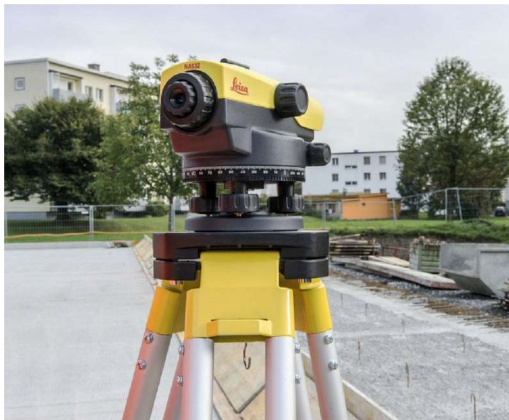
Figura 7. Nivelă optică pentru verificarea stabilității grinzilor de referință
