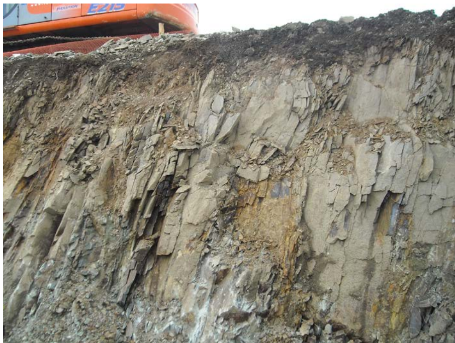
Figura 21. Stare de fisurare rocă - șist verde – în zona Dobrogea
