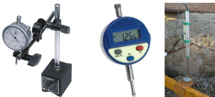
Figura 6. Microcomparator cu sistem magnetic de instalare cu ceas analog (stânga), cu afișare digitală (mijloc) și traductor electronic (dreapta)
