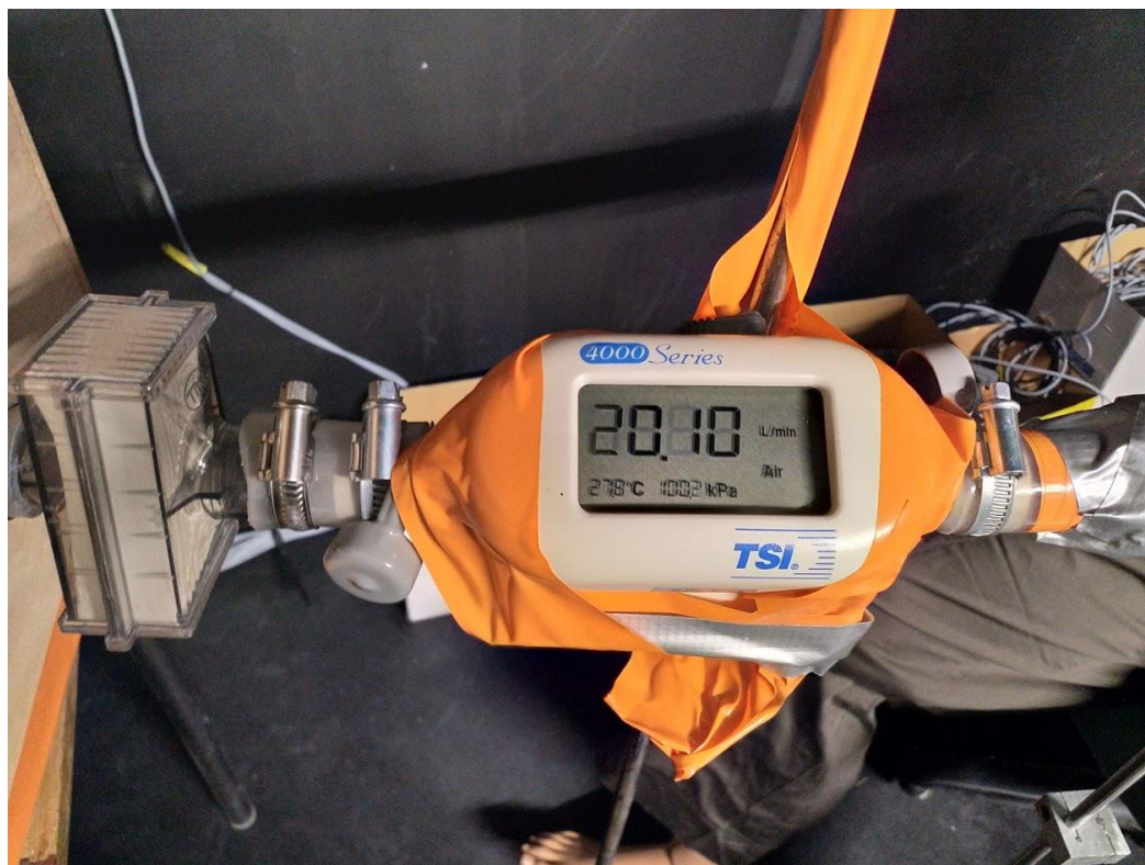
Figura 37 Debitmetrul TSI în timpul măsurătorilor.
