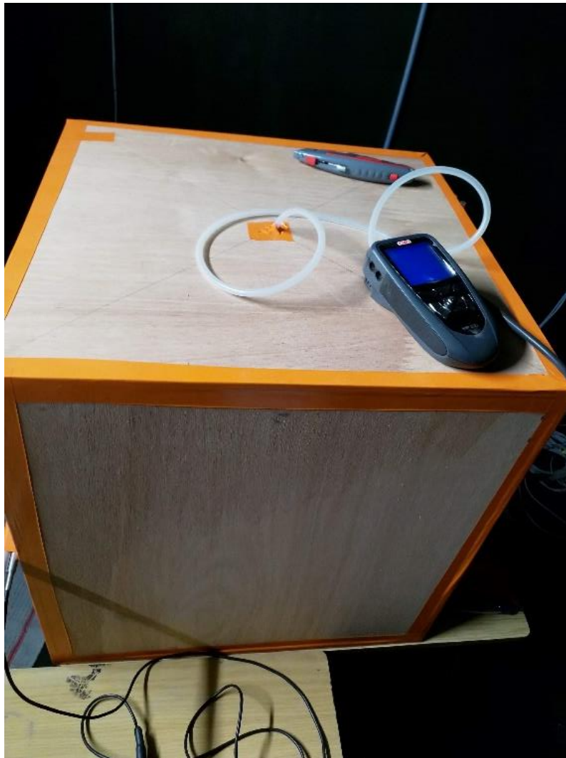
Figura 17 Priza de presiune și manometru diferențial
