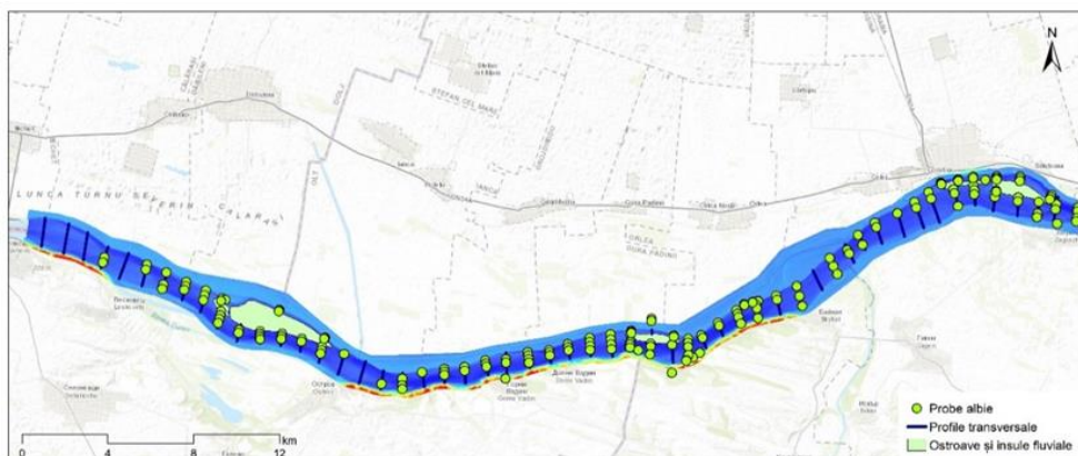
Figura 18. Puncte de prelevare a probelor de sedimente (sectorul dunărean Bechet-Corabia)
