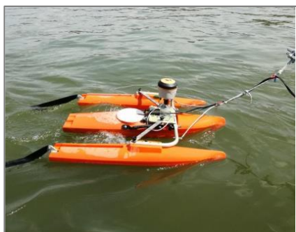
Figura 13. Sistem ADCP Teledyne RDI RiverRay 600
