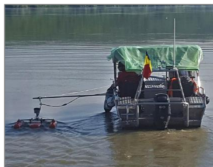
Figura 14. Tractarea sistemelor ADCP în timpul măsurătorilor
