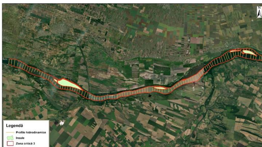
Figura 15. Poziția profilelor hidrodinamice pe zona critică 3 (Bechet-Corabia)
