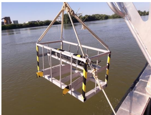
Figura 16. Instrumentul LISST-200X în timpul utilizării
