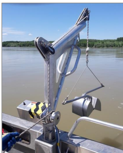
Figura 17. Greiferul Hydrobios și troluul electric utilizate pentru prelevarea probelor din albie
