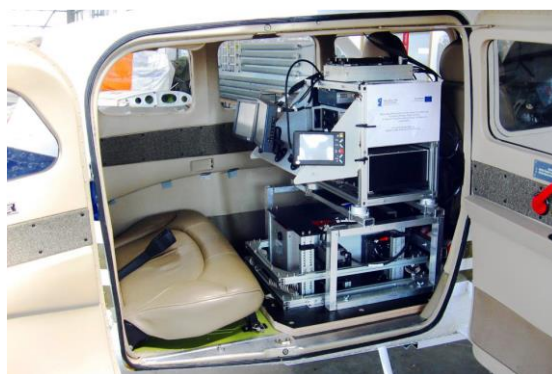
Figura 8. Sistem LiDAR LiteMapper 6800i instalat în aeronavă
