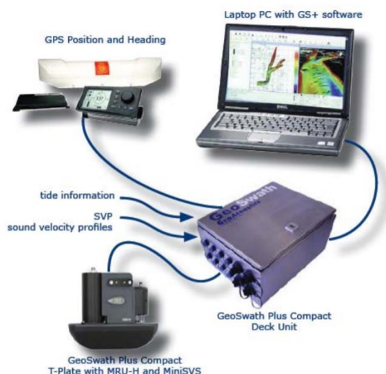
Figura 13. Componentele sonarului interferometric Kongsberg GeoSwath Plus
