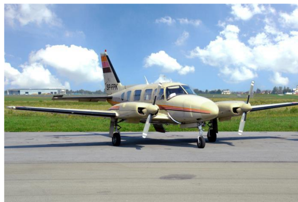
Figura 7. Piper Navajo PA-31, modificat pentru scanare LiDAR
