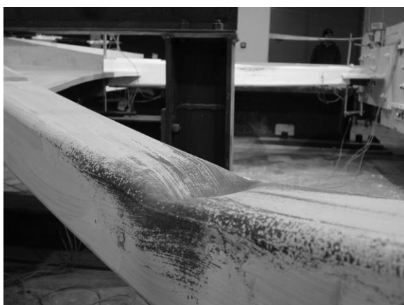
Fig. 1. 14 Deformații remanente sub solicitări de compresiune produse de fenomene de voalare [5]
