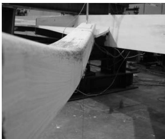
Fig. 1. 15 Deformații remanente la nivelul guseelor sub solicitări de compresiune [3]
