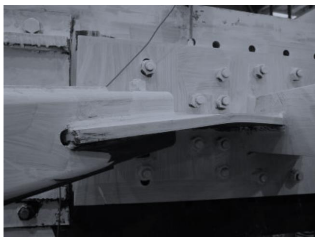
Fig. 1. 15 Deformații remanente la nivelul guseelor sub solicitări de compresiune [3]
