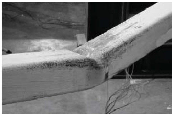
Fig. 1. 14 Deformații remanente sub solicitări de compresiune produse de fenomene de voalare [5]
