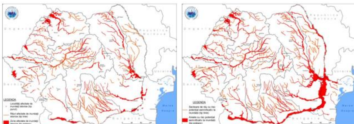
Figura nr. 15. Localizarea zonelor indentificate în etapa de evaluare preliminară a riscului la inundații: a) zonele afectate de inundațiile istorice semnificative; b) zonele cu risc potențial semnificativ la inundații
