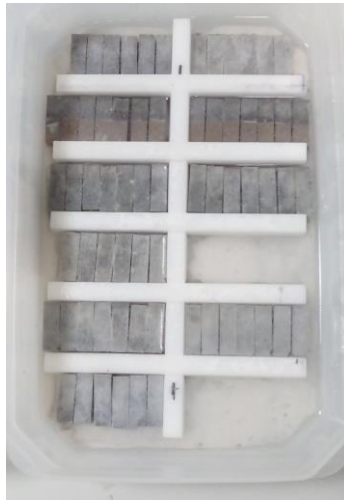
Figure 6 Echantillons pendant la période d'hydratation conservés dans un bain d'eau saturée en chaux
