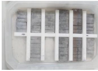
Figure 4 Échantillons conservés dans un bain d'eau saturée en chaux pendant la période d'hydratation
