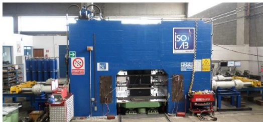
Figura 4.4.1.3-1 Echipament cu capacitatea de încărcare verticală de 50000 kN
