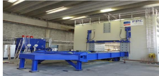
Figura 4.4.1.3-2 Echipament cu capacitatea de încărcare verticală de 70000 kN
