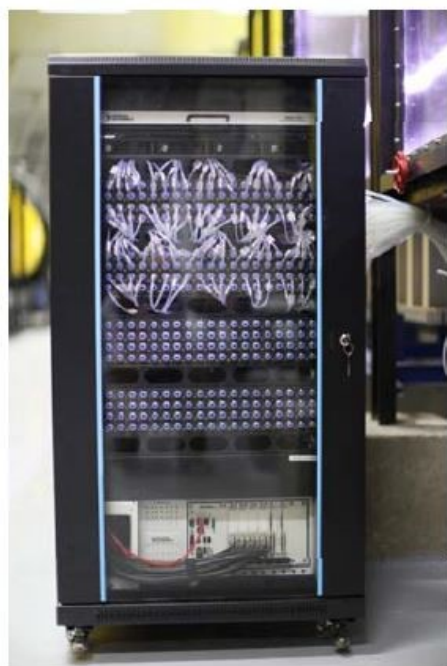
Figura 3.9 – Scannerul de presiune miniatural 300 de traductori, aflat în dotarea Laboratorului de Aerodinamică și Ingineria Vântului ”Constantin Iamandi”
