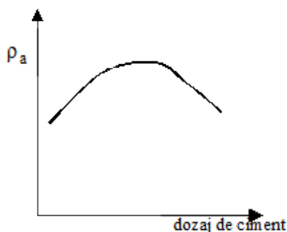
Figura II.3. - Variația densității aparente a betonului cu dozajul de ciment [31]
