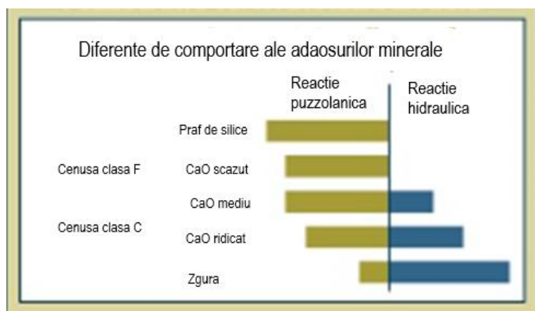
Figura I.1. - Efectele hidraulice/puzzolanice calitative ale adaosurilor minerale
