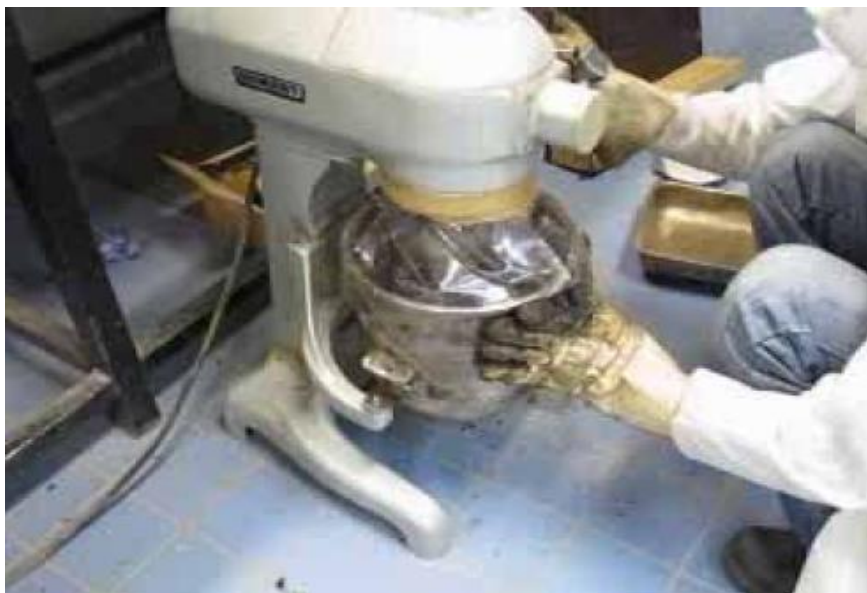
Figura 23. Malaxarea mixturii asfaltice
