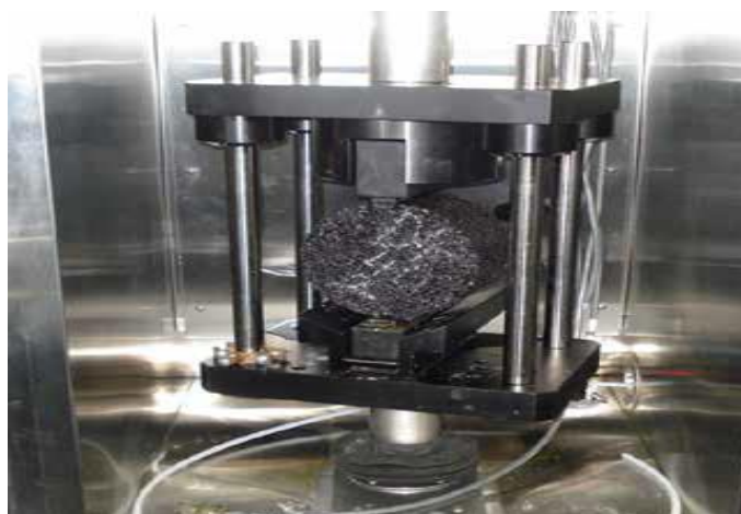
Figura 34. Încercarea de întindere indirectă IDT
