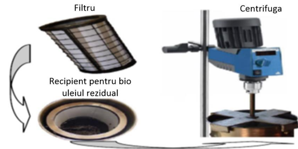
Figura 49. Metoda de obținere a bio uleiului rezidual
