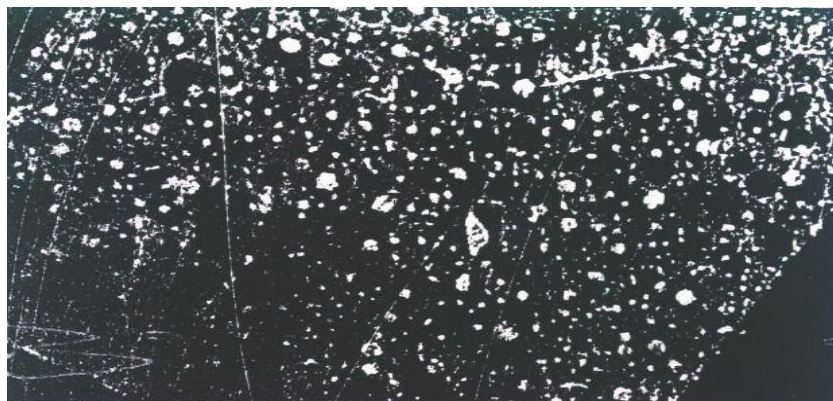
Figura 32. Microfotografia, în lumină fluorescentă, a bitumului modificat cu CAPS
