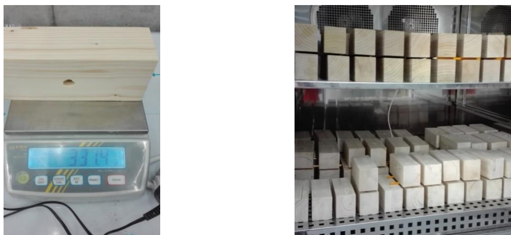
Figura 5.15 Balanța folosită pentru cântărirea specimenelor din lemn înainte și după uscarea în cuptor și aranjamentul pieselor din lemn în camera climatică în care au fost introduse
