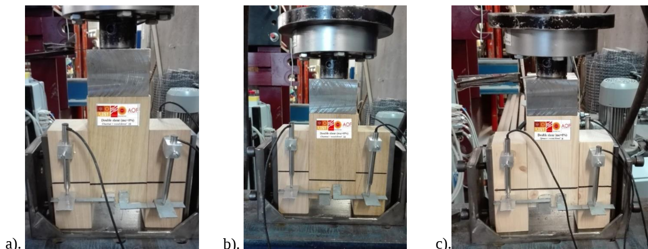
Figura 5.28 Evoluția îmbinărilor din lemn cu mc=8\% după aplicarea forței pentru cele două esențe folosite: castan (a, b) și molid (c)
