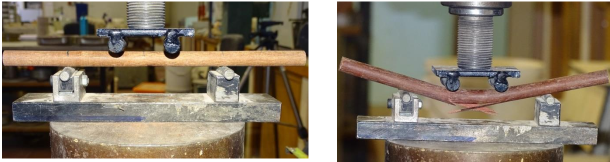
Figura 5.4 Experimentele realizate pe încovoierea dornurilor înainte și după aplicarea forței
