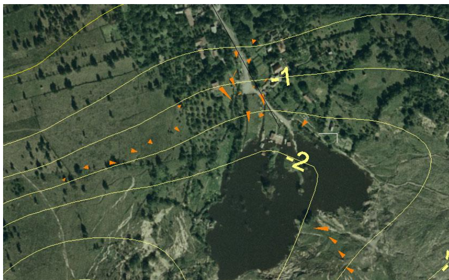
Fig.4. 32 Detaliu cu vectorii de mișcare ai reperilor, în general perpendiculari pe curbele de egală subsidență
