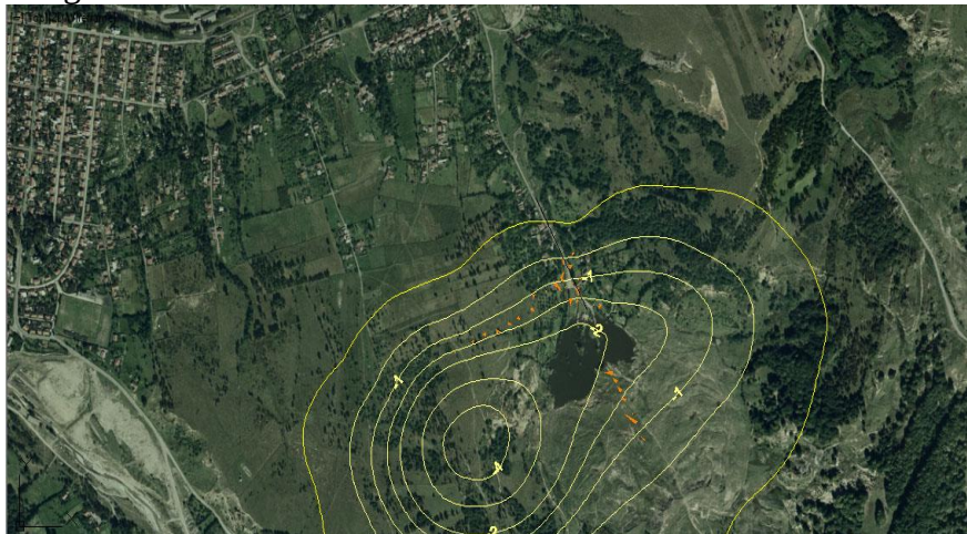
Fig.4. 31 Zona Defor cu curbele de egală subsidență și vectorii de mișcare ai reperilor de monitorizare. Se poate observa poziția și forma albiei de scufundare, care are în zona centrală lacul de subsidență și care acoperă o suprafață de 92,56 ha. Albia de scufundare avansează, odată cu exploatarea subterană, spre nord, apropiindu-se de intravilan
