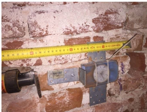
fig.2.17-incercare nedistructiva zidarie-sclerometru si semidistructiva cu presa ,cladirea 1930, CALEA VICTORIEI
