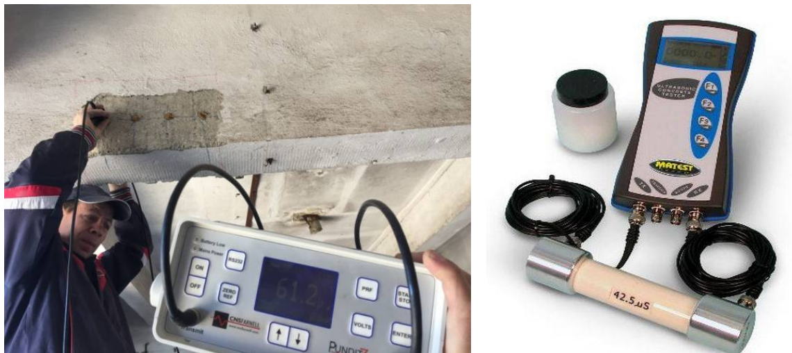
fig.5.2 -INCERCARE BETON GRINDA; BETONOSCOPI
