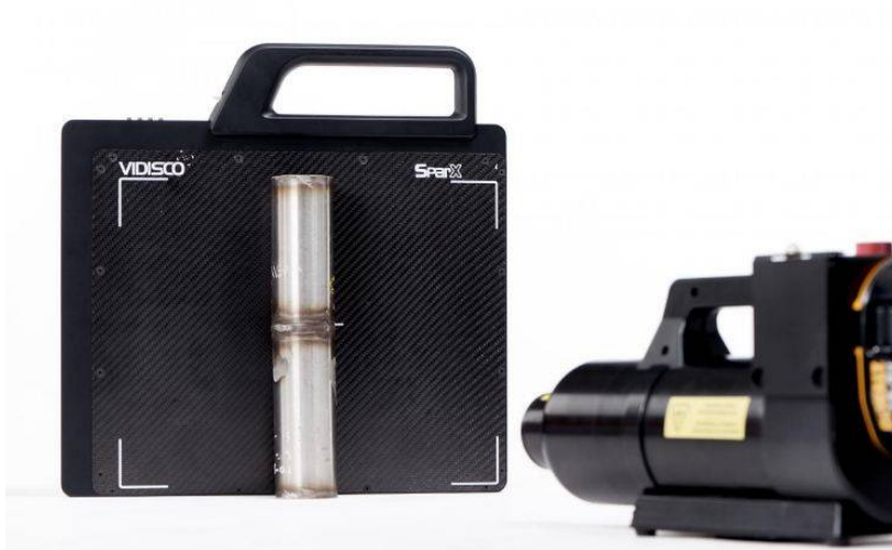
fig 6.1.1. SISTEM RADIOGRAFIE 2D -MODEL RAZOR 2K ,USA
