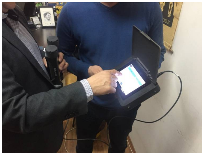
fig 6.2.2.6. -teste imagistica efectuate la UTCB-catedra de CIVILE,pe un perete B.A impreune cu specialistul PROCEQ,LUBOS MISAK IN DATA DE 17.04.2018
