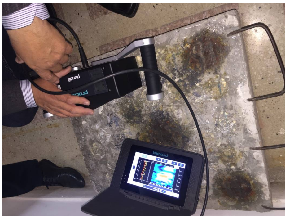
fig. 6.2.4.8. . -teste imagistica PULSE-ECHO efectuate la UTCB-LABORATOR DE MATERIALE pe un bloc test impreune cu specialistul PROCEQ,LUBOS MISAK IN DATA DE 17.04.2018-COMPARATIE CU IMAGISTICA BAZATA PE CURENTI EDDY-PROCEQ- A FOST OBSERVAT SI OBIECT NEMETALIC INCLUS
