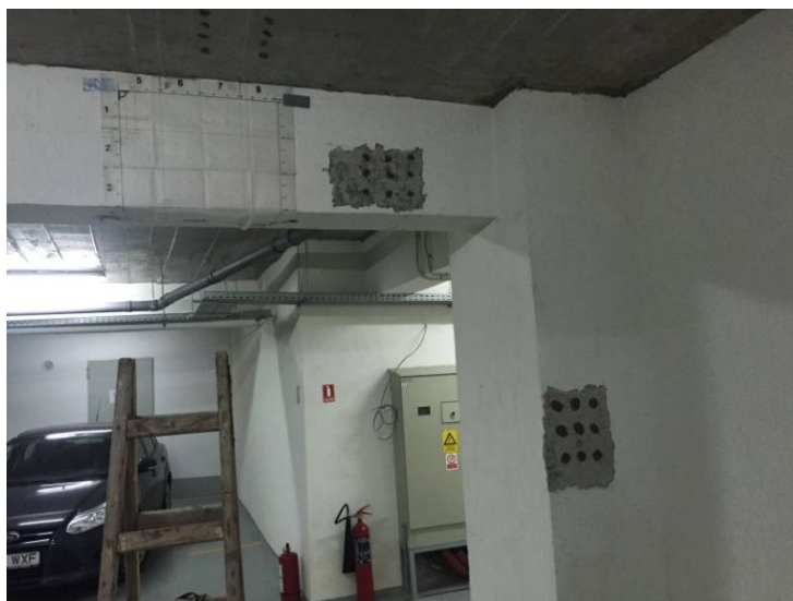
fig.4.3.1.subsol cladire interbelica reabilitat cu mortar MAPEI -teste ultrasunete
