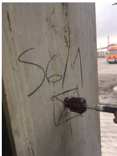
fig.4.2.6 .Cladire profile metalice afectata de foc -incercari durometrice
