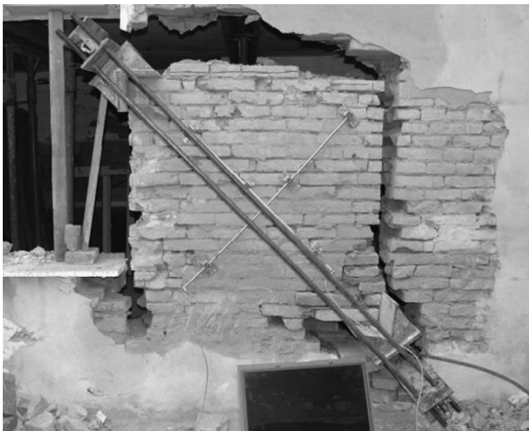
fig 5.3.2.7.19 . Incercare la compresiune diagonala cu prese
