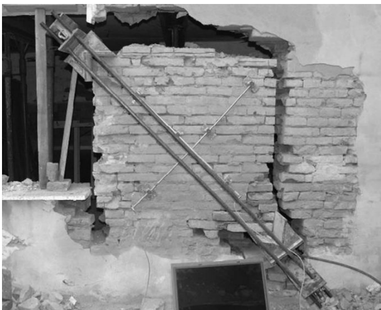
fig 5.3.2.7.19 . Incercare la compresiune diagonala cu prese
