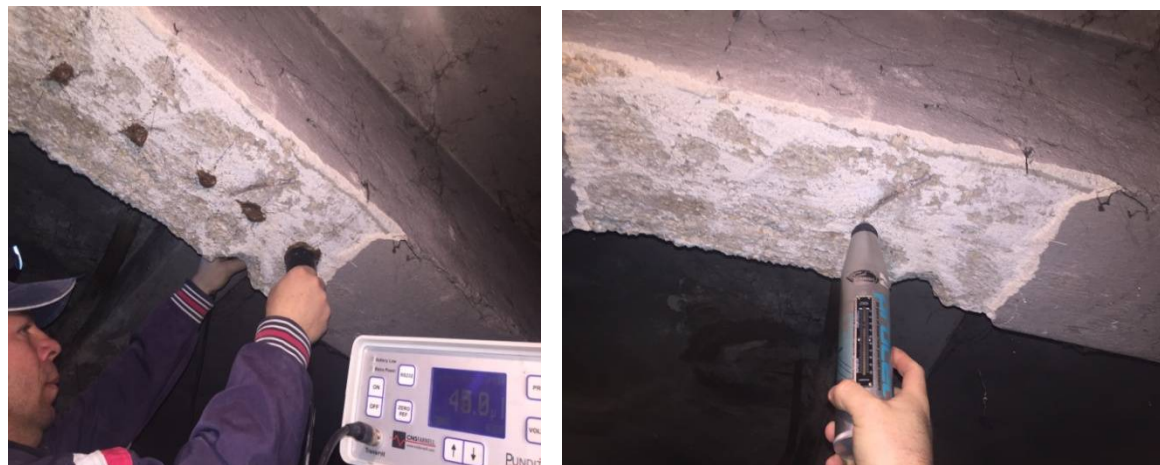
fig 5.8.2 Metoda combinata aplicata la stalpi subsol cladure S+P+6E 1936- blvd.MAGHERU ,BUCURESTI
