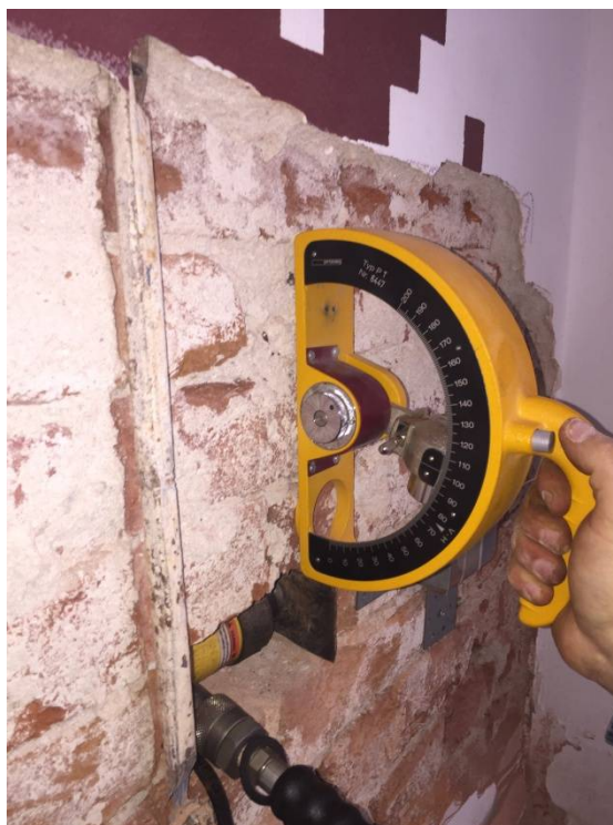
fig 3.2 Incercari in situ cu sclerometrul de zidarie cladire interbelica : Rezultatele confirma rezultatele obtinute la presa pe zidaria cpp.
