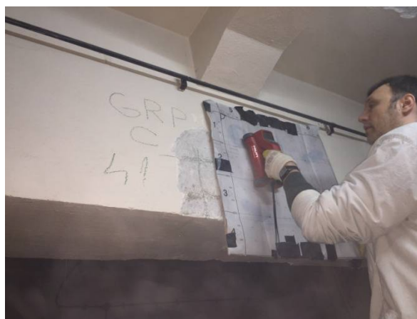
fig 5.17 .Pregatire fata 1 perete cu pahometrul .Pregatire fata 2 perete cu pahometrul
