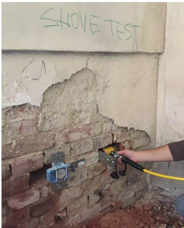
fig 3.4 test PRESA 10 t+micrometru pentru determinarea deplasarilor
