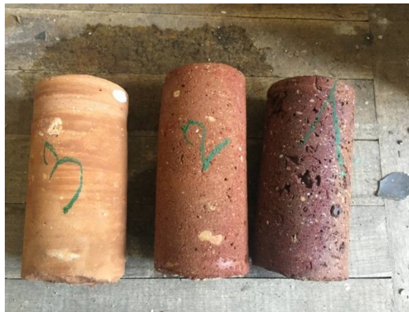
fig.5.3.2.12 a) carotare perete zidarie subsol uscata .b) carote din pereti diferiti
