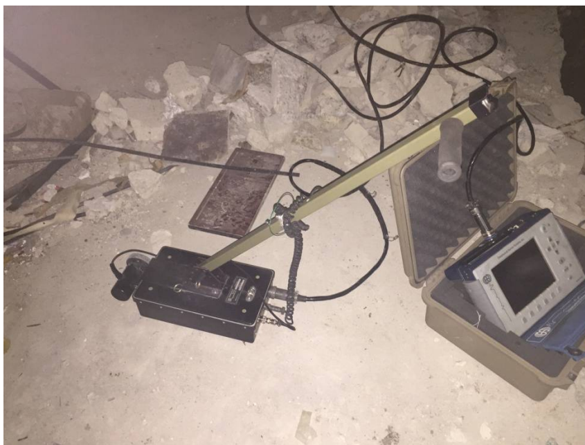
fig.2.9.7 Determinare sistem fundare clădire CALEA MOSILOR -determinari cu georadarul si antena 900 mhz
