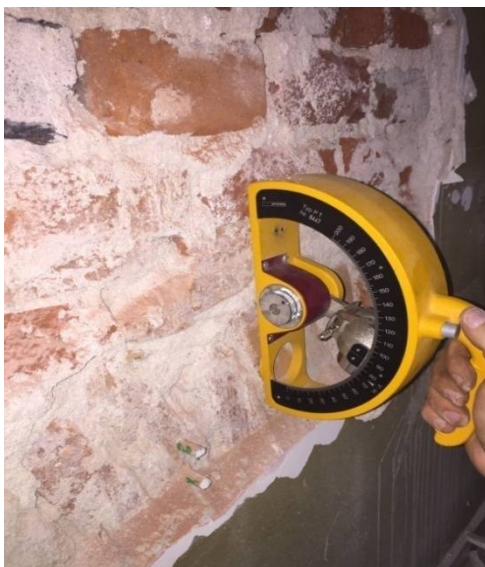
fig 5.3.2.1.sclerometru PROCEQ tip O mortar si caramida tip L-
