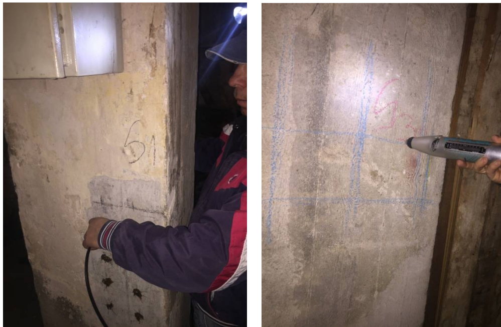
fig 5.8 Metoda combinata aplicata la stalpi subsol cladure s+p+3e 1920- centru vechi,bucuresti
