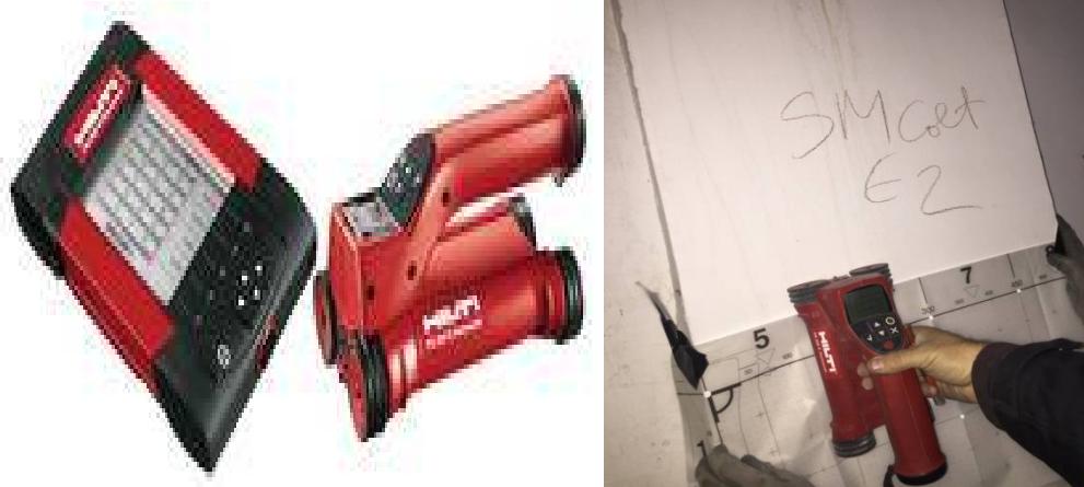
fig 5.15 . sistem cu vizualizare 2 d a barelor/diametrelor pe santier.
