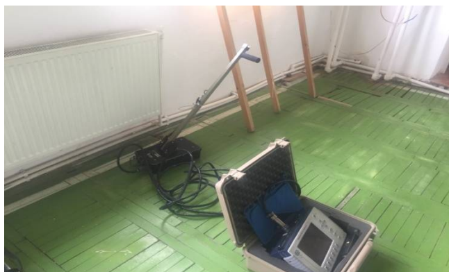
fig.6.2.3.2 Echipament :STATIE +ANTENA 900 MHZ si PROFIL 2D PLANSEU B.A.
