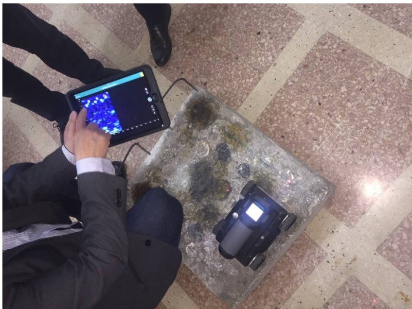
fig 6.2.3.11 . -teste imagistica RADAR efectuate la UTCB-catedra de CIVILE,pe un bloc test impreune cu specialistul PROCEQ,LUBOS MISAK IN DATA DE 17.04.2018
