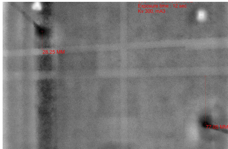
fig 6.1.2. RADIOGRAFIE 2D COS DE FUM BETON ARMAT tehnologie digitala cu raze VISIO X-USA-SE OBSERVA SI ELEMENTE NEMETALICE SI METALICE
