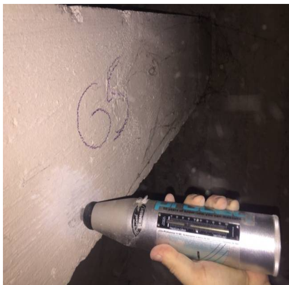
fig 3.7 Determinarea rezistentei betonului prin metoda COMBINATA
