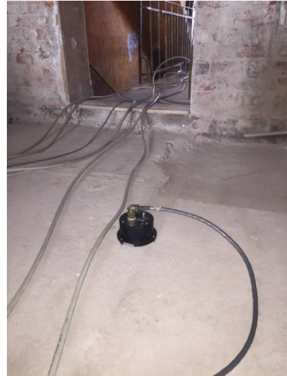
fig 7.2.51 .Mt.WHITNEY -KINEMATRICS 18 CANALE SI ACCELEROMETRU,CABLURI .SUPLIMENTAR A FOST FOLOSIT SI O STATIE CU 4 CANALE -KINEMATRICS K2-ALTUS
