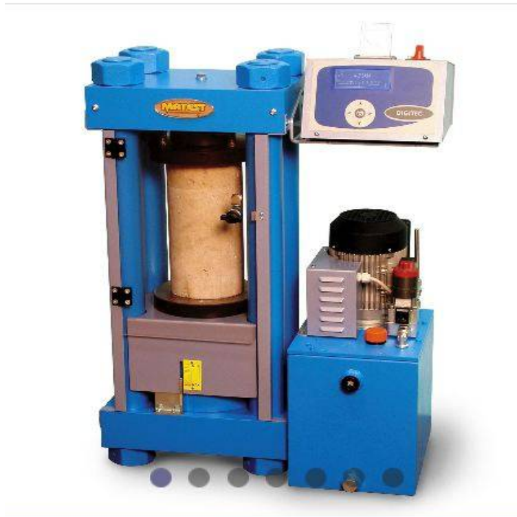
fig.5.19 incercare carote la presa
