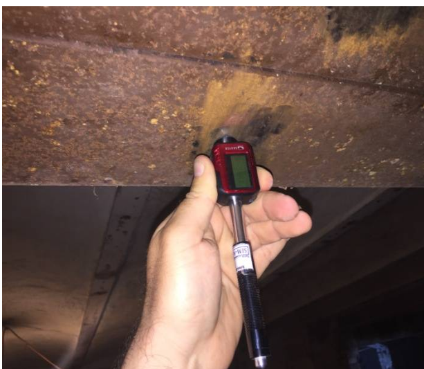
fig.4.2.4 .Cladire 1930 cu zidarie subsol+profile metalice planseu subsol afectate de umezeala pe termen lung :
