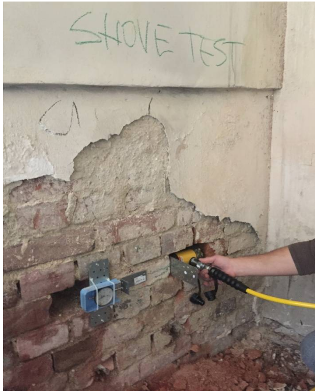
fig 3.4 test PRESA 10 t+micrometru pentru determinarea deplasarilor
