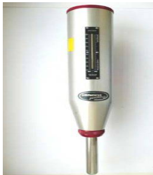
fig 5.3.2.1.sclerometru PROCEQ tip O mortar si caramida tip L-
