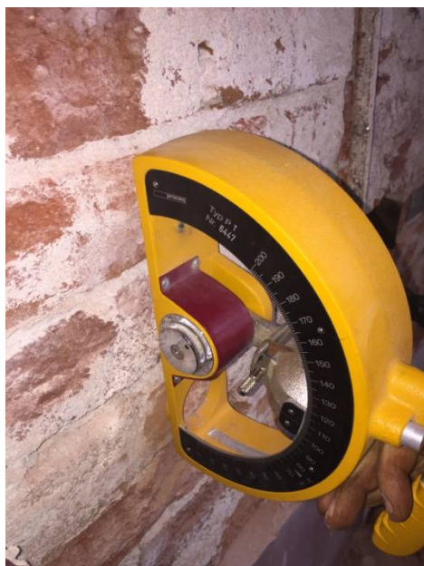
fig.2.17-incercare nedistructiva zidarie-sclerometru si semidistructiva cu presa ,cladirea 1930, CALEA VICTORIEI
