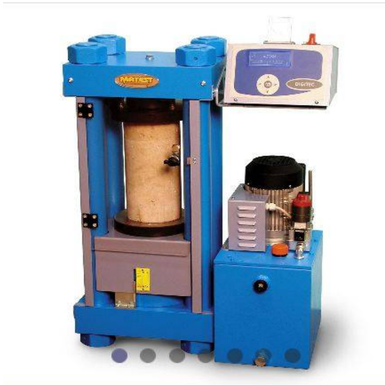
fig.5.19 incercare carote la presa
