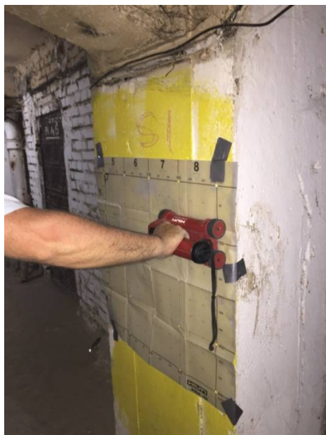
fig 3.8 Metoda combinata ULTRASUNETELOR+SCLEROMETRIE-nedistructiv -pentru a asigura o detectie superioara se folosesc aparate moderne .
