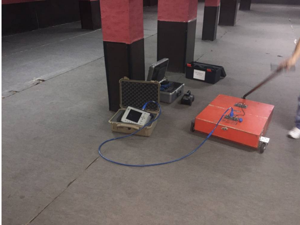
FIG 5.10 :RADAR PENTRU UTILITATI : 300 MHZ
