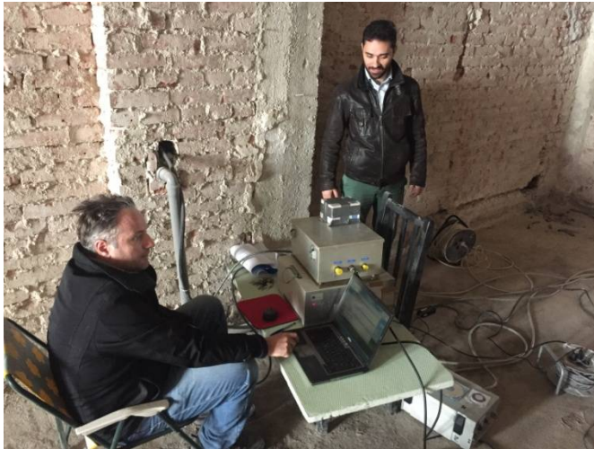
fig 7.2.51 .Mt.WHITNEY -KINEMATRICS 18 CANALE SI ACCELEROMETRU,CABLURI .SUPLIMENTAR A FOST FOLOSIT SI O STATIE CU 4 CANALE -KINEMATRICS K2-ALTUS
