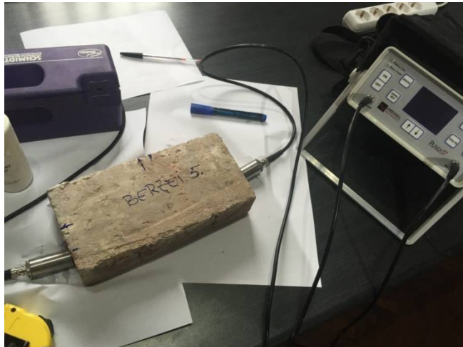
fig 5.3.2.3.sclerometru -incercare caramida cpp cu ultrasunete in laborator
