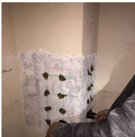
fig 3.7 Determinarea rezistentei betonului prin metoda COMBINATA
