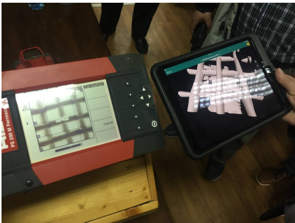
fig 6.2.3.12 . -teste imagistica RADAR efectuate la UTCB-catedra de CIVILE,pe un bloc test impreune cu specialistul PROCEQ,LUBOS MISAK IN DATA DE 17.04.2018
