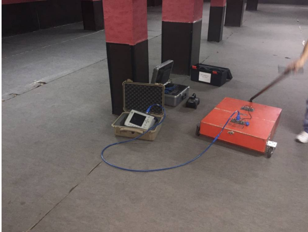
FIG 5.10 :RADAR PENTRU UTILITATI : 300 MHZ
