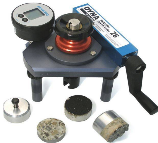
fig.5.19.1 incercare cu presa in situ la intindere pe carote ;schita incercare cu presa in situ la intindere pe carote
