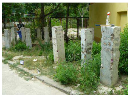
Foto 1. Amenajarea în zona urbană (București) a unui poligon de încercare „in situ” a betoanelor preparate cu cimenturi „candidat” Portland compozite cu adaos de calcar și “de referință” cu CEM II/A-S 32,5R. Elemente tip „stâlp din beton armat”. Un poligon similar este amenajat și în zona litorală (Constanța) pentru CEM III/A.
