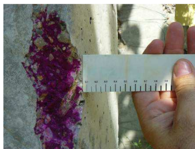
Foto 1. Amenajarea în zona urbană (București) a unui poligon de încercare „in situ” a betoanelor preparate cu cimenturi „candidat” Portland compozite cu adaos de calcar și “de referință” cu CEM II/A-S 32,5R. Elemente tip „stâlp din beton armat”. Un poligon similar este amenajat și în zona litorală (Constanța) pentru CEM III/A.
