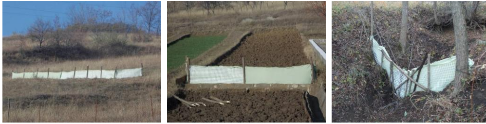
Figura 8.2. Imagini ale celor trei cazuri de bariere, montate pe terenuri cu pante de 20%, 24% și respectiv, 50%
